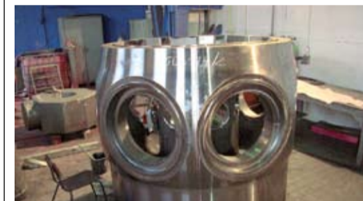
Корпус рабочего колеса после механической обработки на заводе-изготовителе
