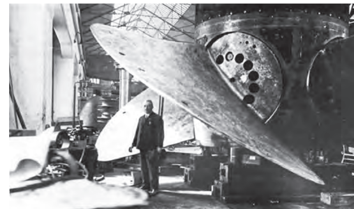
Рабочее колесо турбины ▶ Нижне-Свирской ГЭС Turbine wheel at Nizhne-Svirskaya HPP
